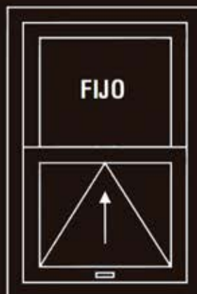
Ouvrant supérieur fixe. Ouvrant inférieur mobile et rabattable
