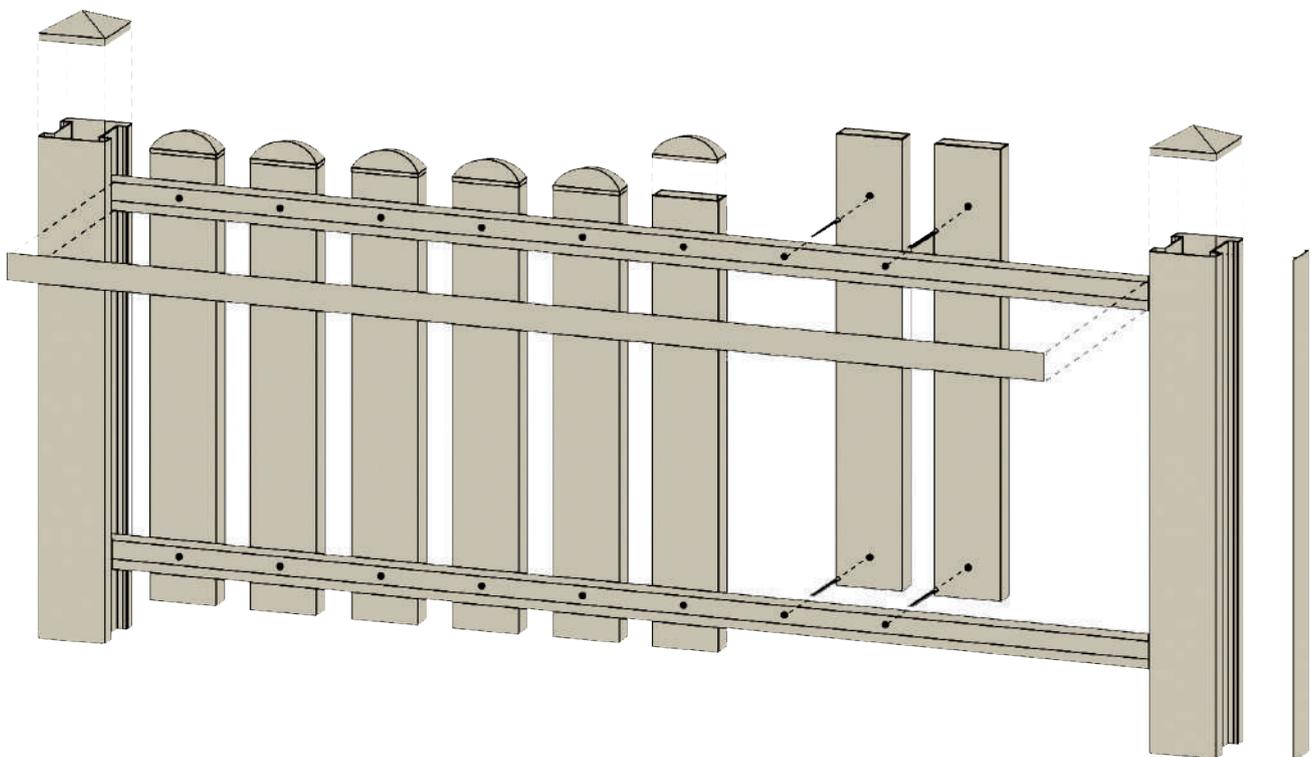
En este plano de montaje podemos observar la sencillez de colocación de nuestras vallas de aluminio, con sistemas fácilmente graduables en caso de descuadres o inclinaciones de las paredes o desniveles del suelo.
